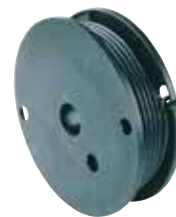
DeLaval заземяващ кабел Свържете заземителните пръти и шлюзовете над или под земята. Кабелът е двойно изолиран и е с цинкувана стоманена проводник. Сила на напрежение приблизително 20 000 V. Кабелът се предлага в три различни дължини: 10, 25 и 100 m. Ø 1.6 mm, 10m. Art. no. 86675501 Ø 1.6 mm, 25m. Art. no. 98767235 Ø 2.5 mm, 100 m. Art. no. 88859601
